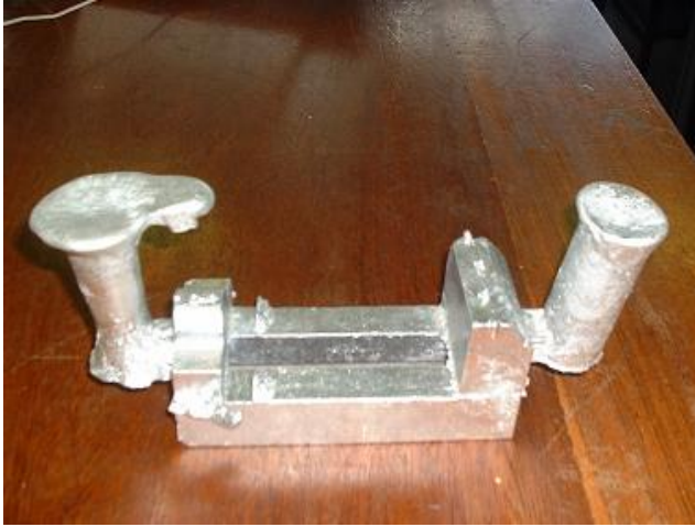
Η χυτευόμενη βάση μαζί με το σαγόνι και το μέρος με βήμα κοχλία και τους πλαϊνούς αγωγούς.
