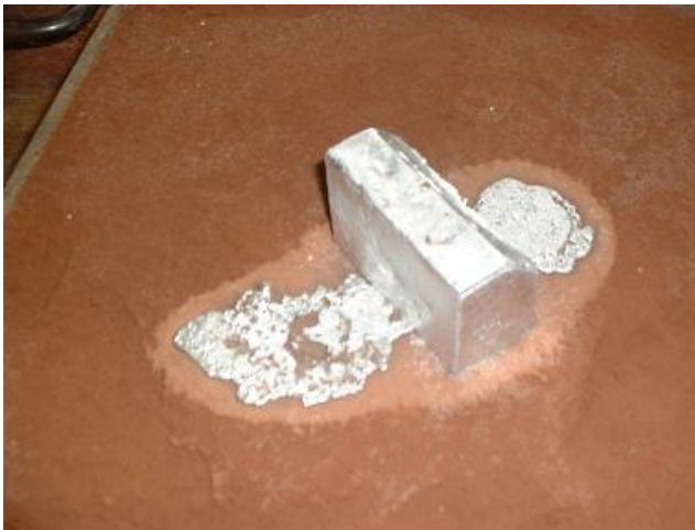
Το χυτευόμενο τμήμα αφού του έχουμε αφαιρέσει την άμμο.
