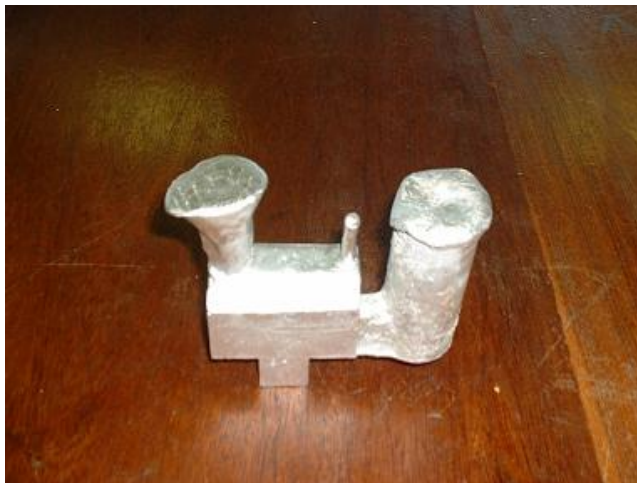
Το δεύτερο χυτό κινούμενο σαγόνι χωρίς κανένα ελάττωμα.
