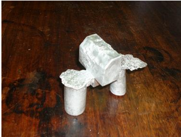
Το χυτό κινούμενο σαγόνι με ελαττώματα στην επιφάνεια του.
