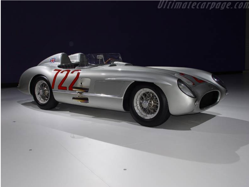
Σχήμα 3.6: Mercedes – Benz 300 – SLR. Το πίσω προστατευτικό κάλυμμα του οδηγού ανασηκώνεται αυξάνοντας το συντελεστή οπισθέλκουσας σε 1.09.
