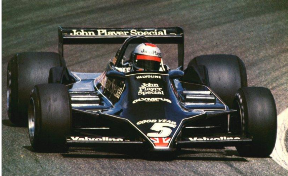
Σχήμα 3.9: Lotus 79 Formula1. Το πρώτο αγωνιστικό όχημα Venturi όπου εφαρμόστηκε η ομώνυμη τεχνολογία αύξησης της στατικής πίεσης για τη βελτίωση της ευστάθειας στο οδόστρωμα.
