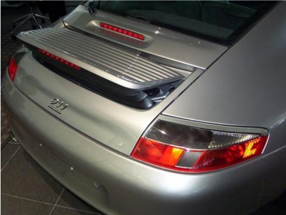
Σχήμα 3.11: Η αεροτομή της Porsche 911 Carrera, σηκώνεται μετά την ταχύτητα των 80 km/h.
