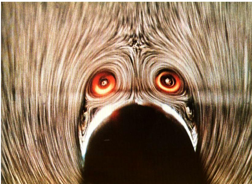
Σχήμα 2.9: Αποκόλληση της ροής σε αμβλύ αντικείμενο.
