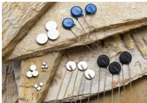
Σχήμα 1.13 Διατάξεις PTC Δίσκου
