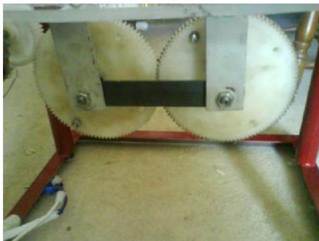
Σχήμα 4.3: Σύνδεση δίσκων - κινητήρα
