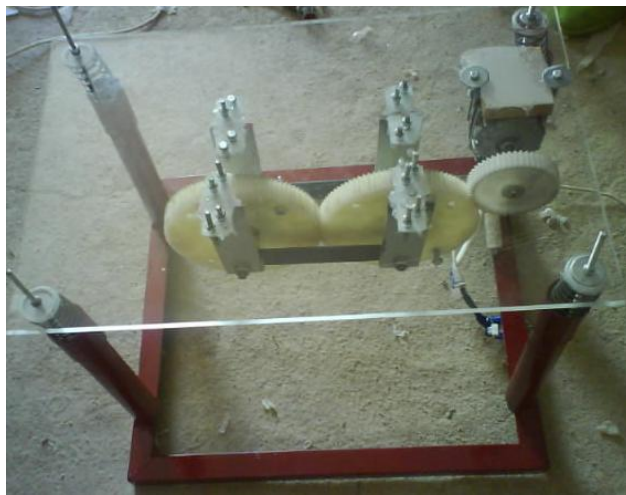
Σχήμα 4.1: Η σεισμική τράπεζα που κατασκευάστηκε
