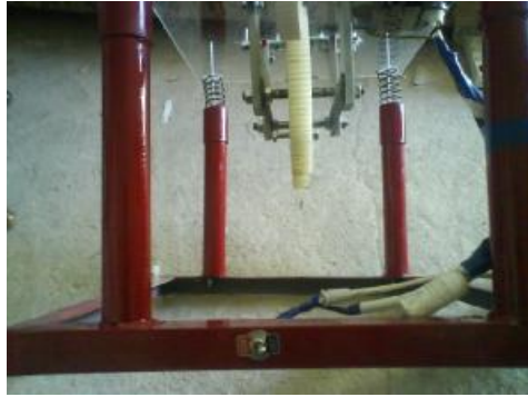
Εικόνα 4.7: Στήριξη δίσκων στην τράπεζα
