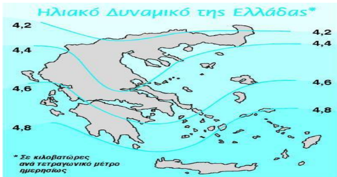
Σχήμα 2 : Ηλιακό δυναμικό σε κιλοβατώρες ανά τετραγωνικό μέτρο ημερησίως.
