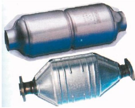
γ. Ωοειδές και κυλινδρικό περίβλημα.
