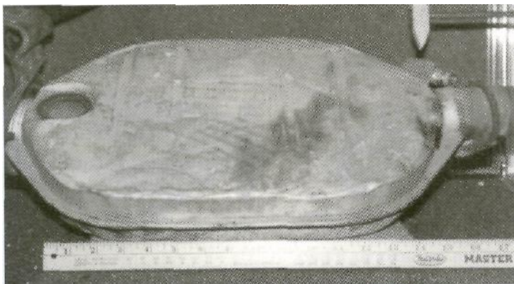
Σχήμα 6: Καταλυτικός μετατροπέας με αντικαθιστώμενα σφαιρίδια
