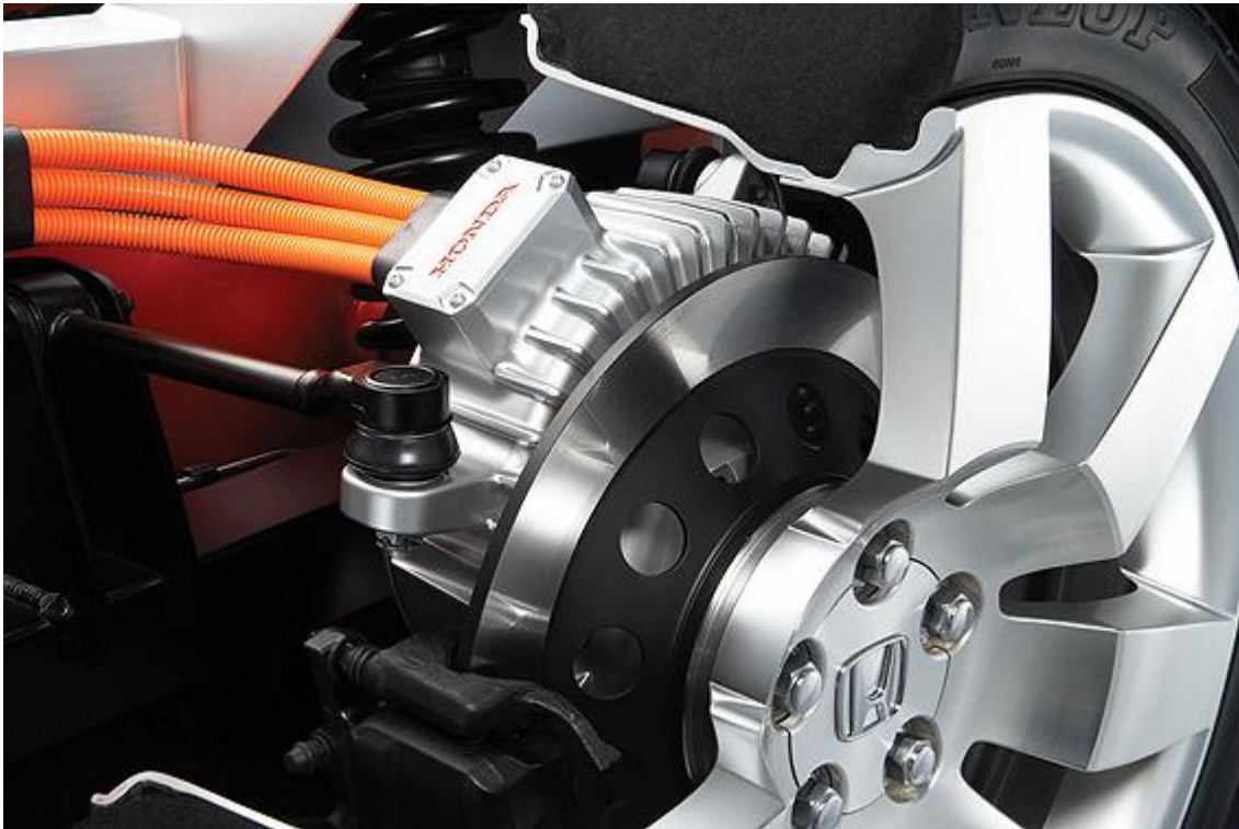
Εικόνα 19 : Ενσωματωμένη μηχανή απόδοσης 25 kW στους πίσω τροχούς / Πηγή : Honda
