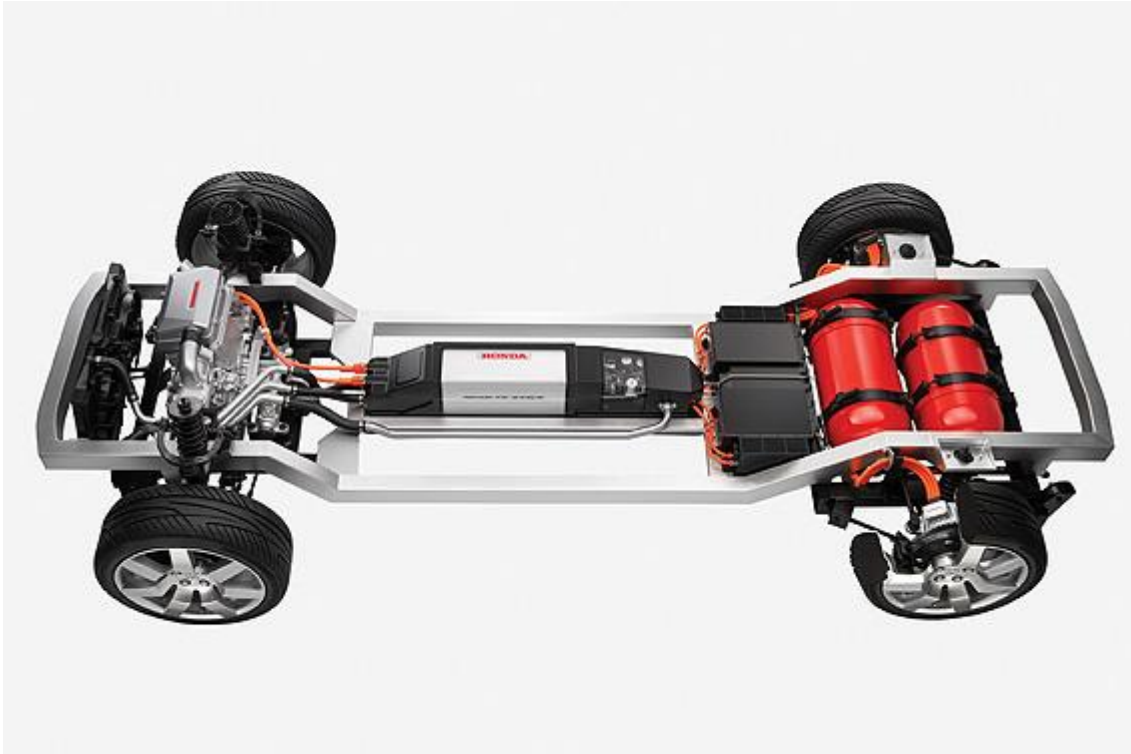
Εικόνα 18: σύστημα ροής 'V'. Κάθετη ροή αερίου, σπονδυλική σχεδίαση, απόδοση σε μικρό όγκο / Πηγή : Honda
