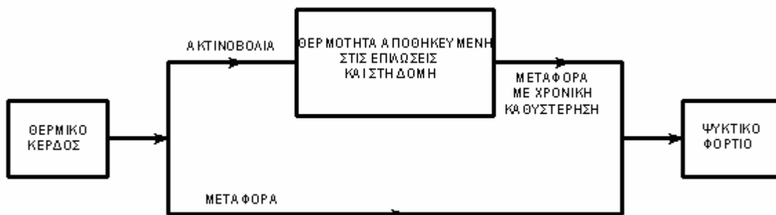
Σχήμα 6.1 Διάγραμμα ροής θερμότητας το οποίο παρουσιάζει τα κέρδη θερμότητας, από αποθήκευση θερμότητας και ψυκτικό φορτίο κτηρίων.
