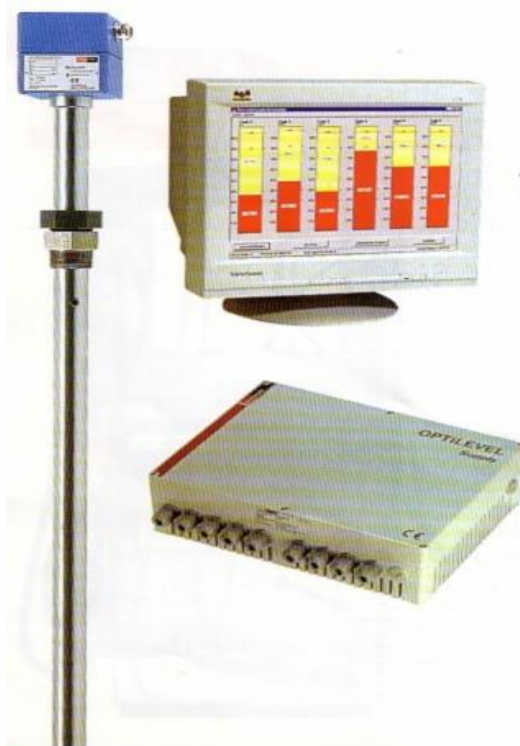
Εικόνα 5 ΗΛΕΚΤΡΟΝΙΚΟ ΣΥΣΤΗΜΑ ΠΑΡΑΚΟΛΟΥΘΗΣΗΣ ΑΠΟΘΕΜΑΤΩΝ ΔΕΞΑΜΕΝΩΝ ΚΑΥΣΙΜΟΥ KIENZLE OPTILEVEL HECTRONIC
