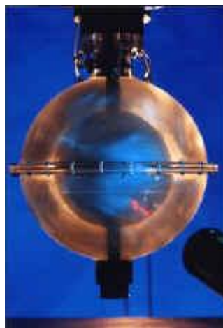
Εικ.3.4: Σφαιρικό πείραμα ροής Couette
