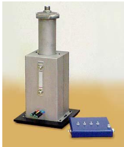
Σχήμα 4.33 Γεννήτρια σωματιδίων για τεχνικές LDA – PIV.
