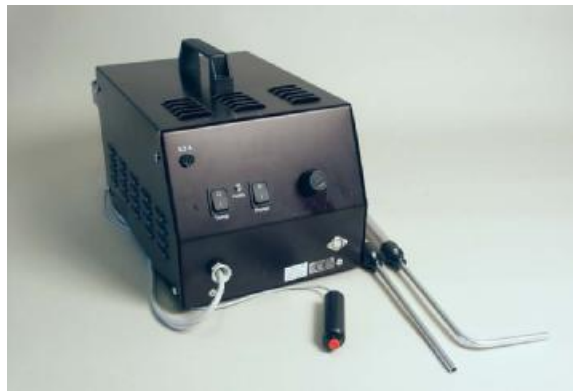
Σχήμα 4.38 Γεννήτρια καπνού για απεικόνιση πεδίων με χρήση LDA – PDA.
