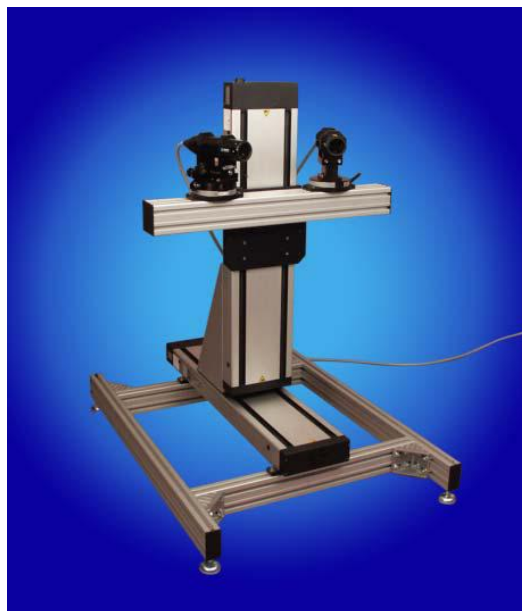
Σχήμα 4.70 Αυτόματοποιημένος μηχανισμός μετακίνησης με κινητήρες για υψηλής ακρίβειας βηματικές μεταβολές.
