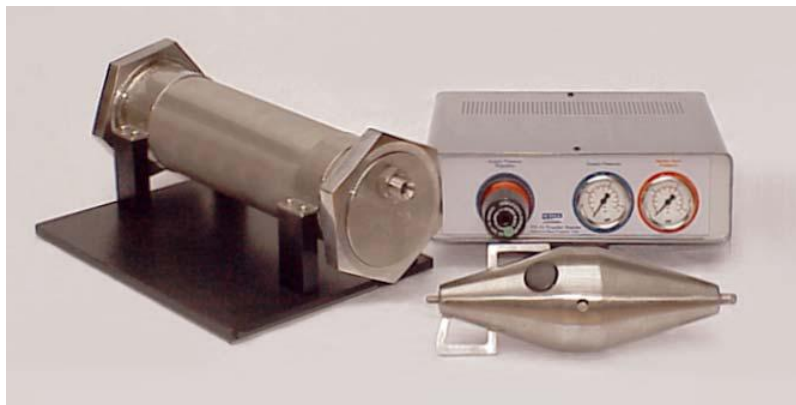
Σχήμα 4.36 Γεννήτρια διασποράς σωματιδίων για μεθόδους LDA – PIV.
