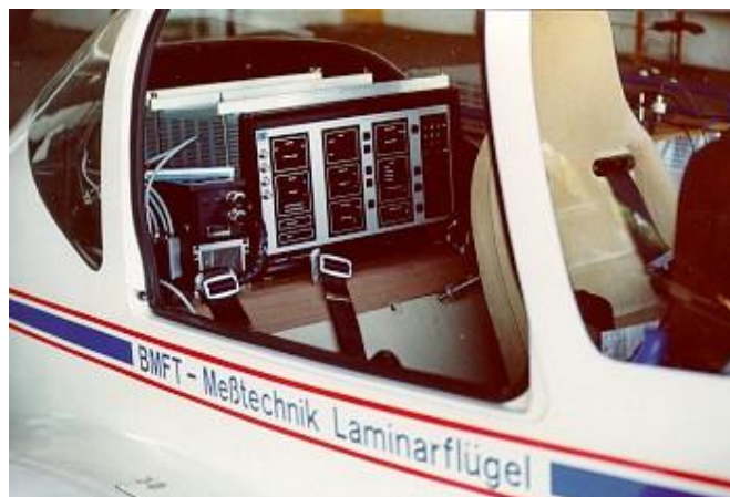
Σχήμα 5 Ο επεξεργαστής BSA της Dantec Dynamics χρησιμοποιήθηκε κατά τη διάρκεια της πτήσης για να αναλύσει τα στοιχεία.
