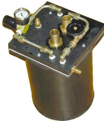
Σχήμα 4.34 Ρυθμιζόμενη Διάταξη σωματιδίων διασποράς.
