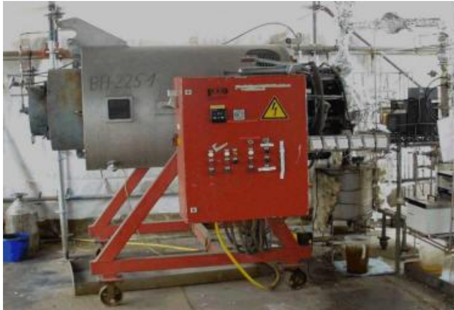
Εικόνα 2.1.4: Εξοπλισμός επεξεργασίας ελαστικού με τη μέθοδο της πυρόλυσης
