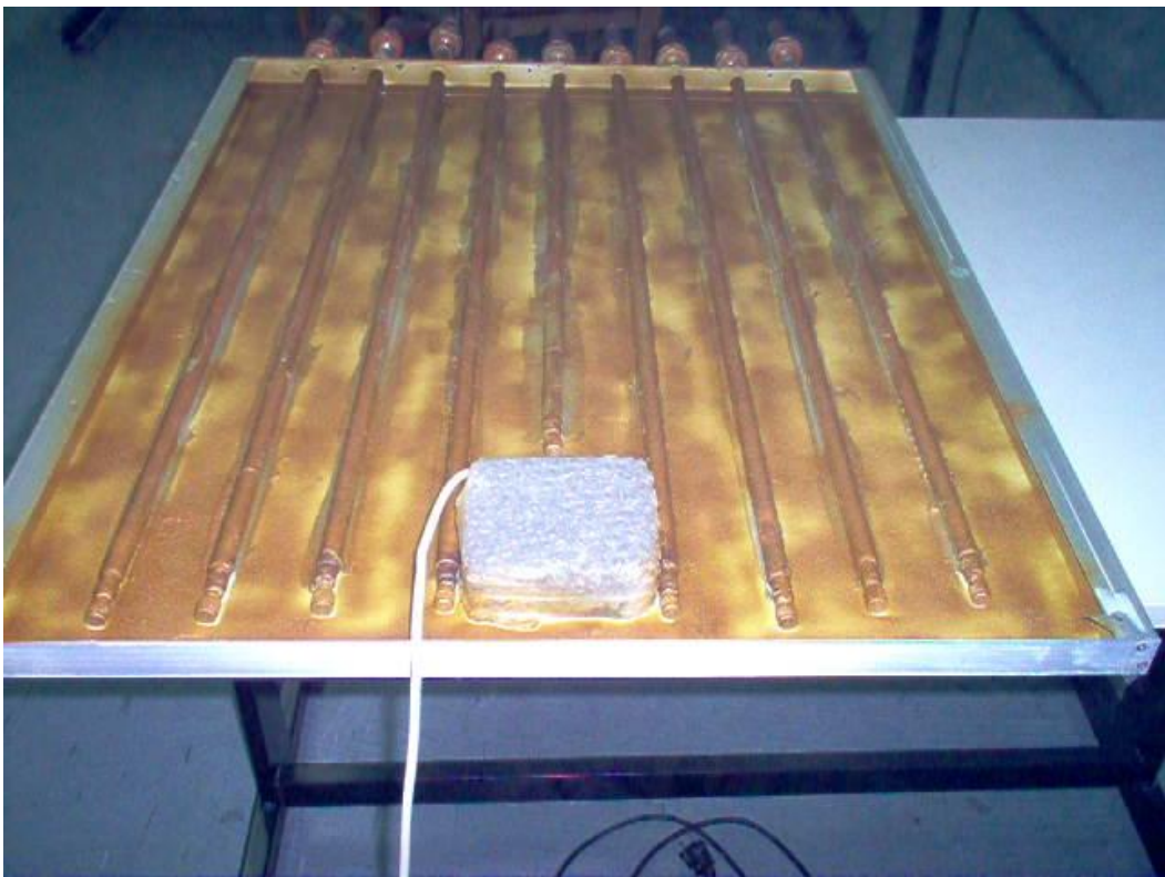
Σχήμα 12 .Άποψη τής επιφάνειας του PV μετά και τον ψεκασμό με το σπρέι χαλκού.
