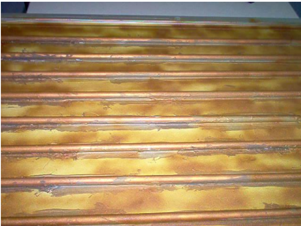
Σχήμα 11 .Αποψη τής επιφάνειας του PV μετά και τον ψεκασμό με το σπρέι χαλκού.
