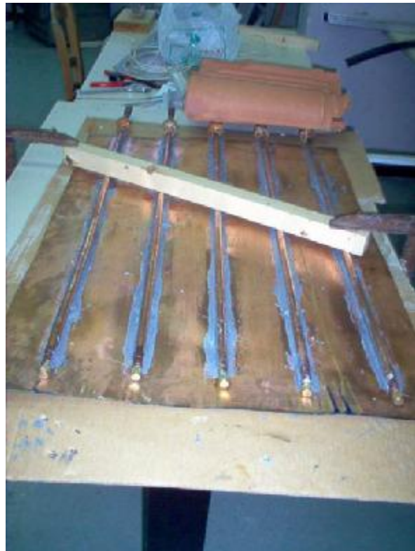
Σχήμα 7. Διαδικασία κόλλησης σωλήνων χαλκού πάνω στο φύλλο του χαλκού.
