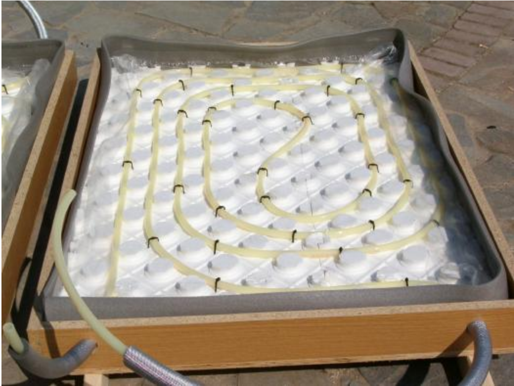
Σχήμα 4.Πλαστικός σωλήνας σε μορφή σερπαντίνας.
