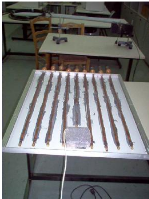
Σχήμα 10 .Διαδικασία κόλλησης σωλήνων χαλκού στη πίσω πλευρά του PV.
