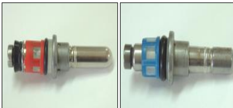
Σχ. 3.33 Ηλεκτροβλαβίδες αντλίας ABS
