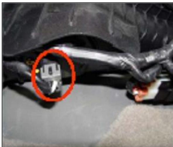
Σχ. 3.41 Αισθητήρας θέσης κλαπέτου κατεύθυνσης αέρα καμπίνας
