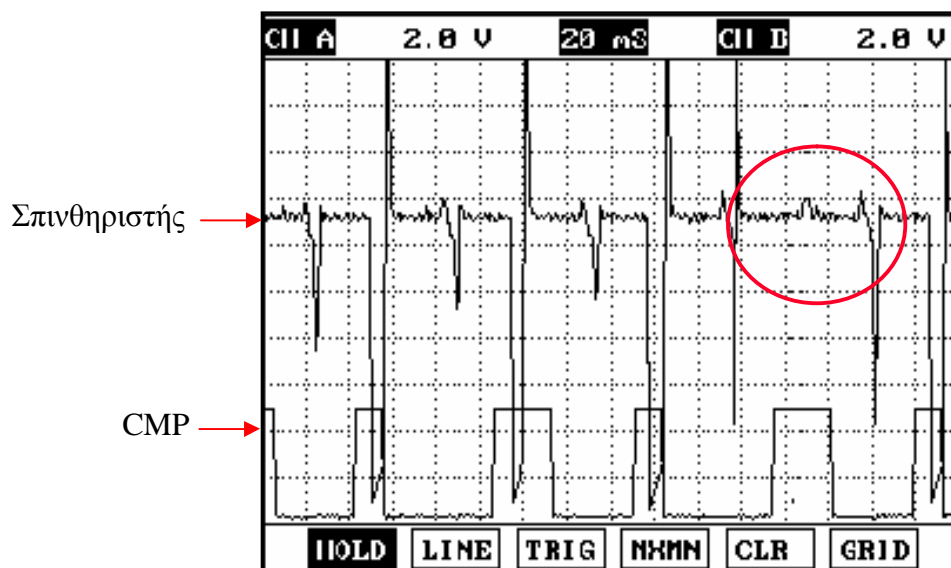
Σχ. 4.25 Έλλειψη κυματομορφής
