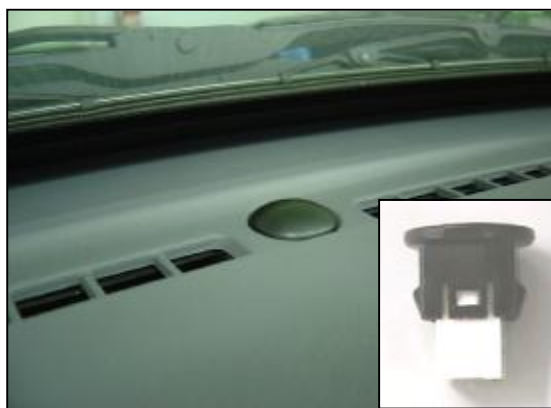
Σχ. 3.40 Αισθητήρας ηλιακής ακτινοβολίας
