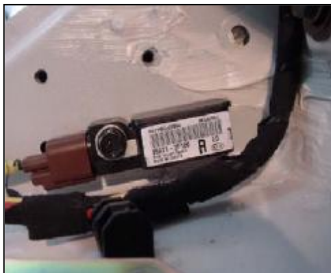
Σχ. 3.45 Αισθητήρας πλευρικής σύγκρουσης
