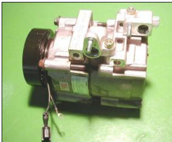
Σχ. 3. 43 Συμπιεστής κλιματισμού
