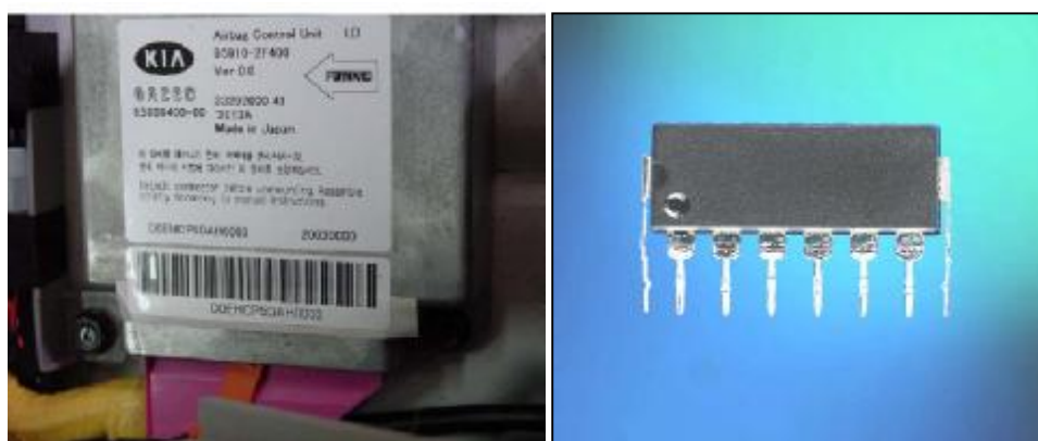
Σχ. 3.46 Αισθητήρας γραμμικής επιτάχυνσης-επιβράδυνσης
