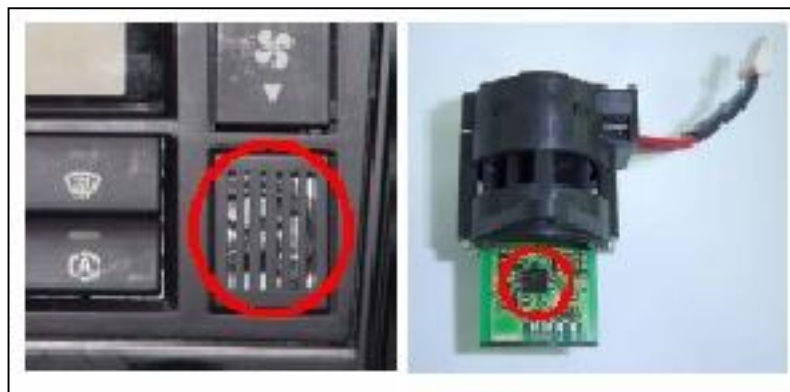
Σχ. 3.38 Αισθητήρες υγρασίας και θερμοκρασίας καμπίνας
