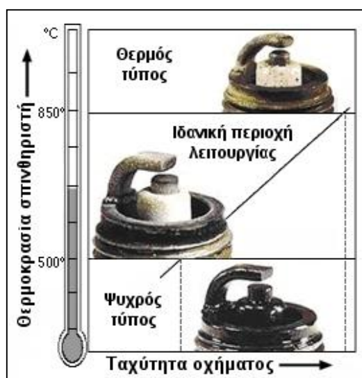
Σχ. 3.30 Διάγραμμα λειτουργίας σπινθηριστή
