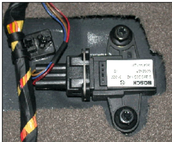
Σχ. 3.35 Αισθητήρες ροπής εκτροπής και πλευρικής επιτάχυνσης
