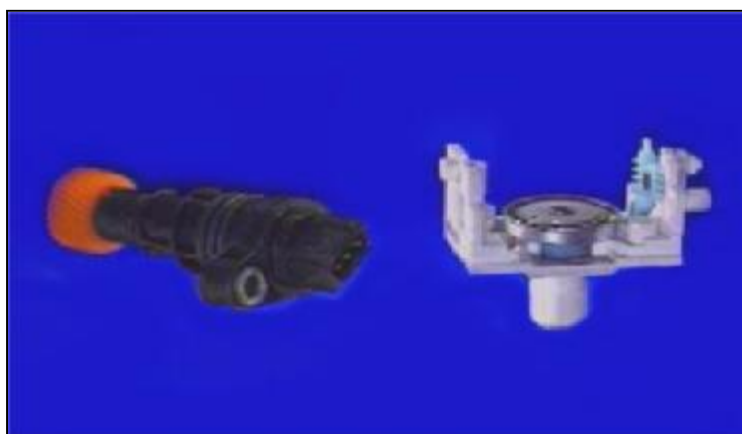
Σχ. 3.18 Αισθητήρας ταχύτητας οχήματος (VSS) (ψηφιακός αριστερά, αναλογικός δεξιά)
