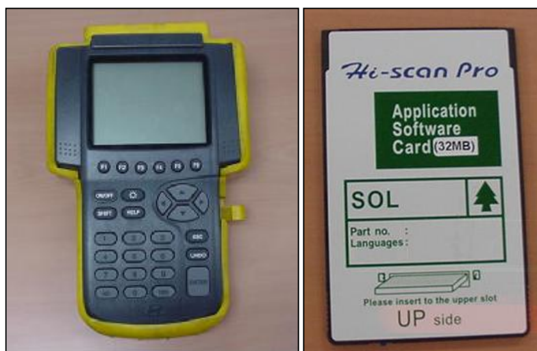
Σχ. 4.1 Συσκευή αυτοδιάγνωσης βλαβών (Hi SCAN-PRO) και κάρτα μνήμης
