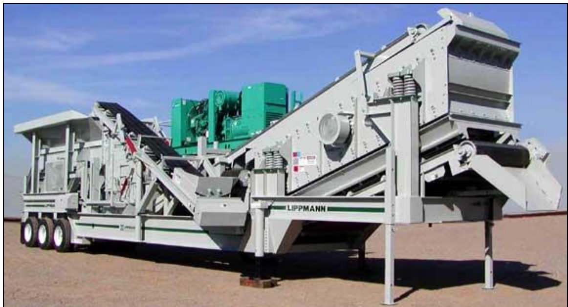
Εικ. 5.5 Ρυμουλκούμενο αυτοφερόμενο συγκρότημα κατασκευής Lippmann
