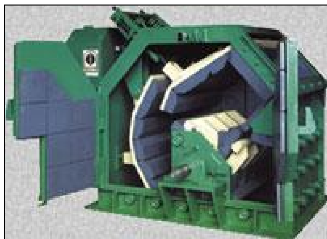
Εικ. 1.8 Περιστροφικός σπαστήρας με κρουστήρες για παραγωγή 150 τόνων ανά ώρα
