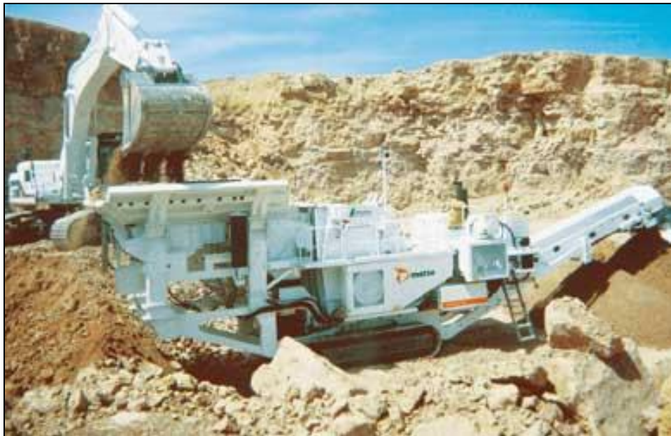
Εικ. 5.3 Ερπυστριοφόρο αυτοφερόμενο συγκρότημα κατασκευής Metso
