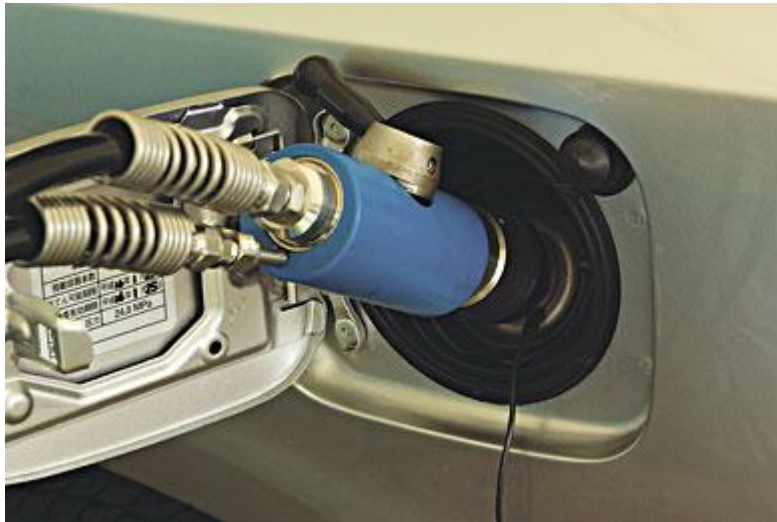
Εικόνα 5.1: Τροφοδότηση των ενεργειακών κυψελών(fuel cells) αυτοκινήτου με καύσιμο.
