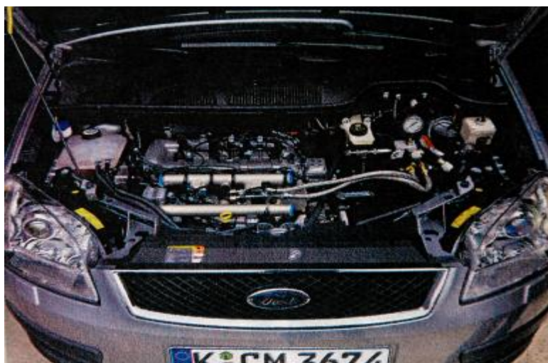
Εικόνα 7.16: Ο κινητήρας των 2300cc του Ford Focus C-MAX H2 ICE.
