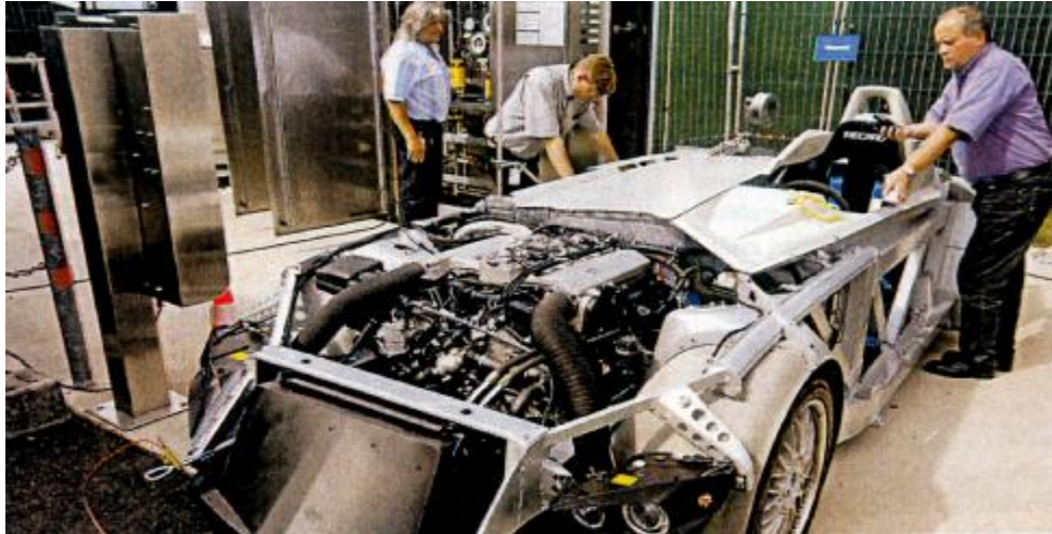
Εικόνα 7.23: Το αλουμινένιο χωροδικτύωμα της H2R, οι αναρτήσεις και το σύστημα διεύθυνσης προέρχονται από το roadster Z8.
