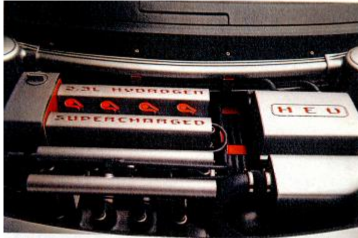
Εικόνα 7.13: Ο υδρογονοκινητήρας των 2.3 λίτρων του Ford Model U.
