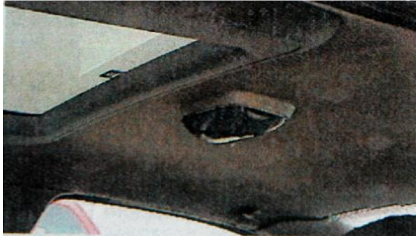
Εικόνα 7.11: Αισθητήρας ελέγχου ύπαρξης διαρροής υδρογόνου στο χώρο των επιβατών του Ford P2000.
