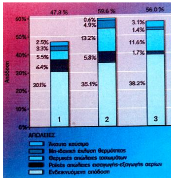
Εικόνα 6.9: Σύγκριση του βαθμού απόδοσης μιας σημερινής τυπικής μηχανής βενζίνης στοιχειομετρικού μίγματος με άμεσο ψεκασμό(1), μιας σημερινής τυπικής μηχανής πετρελαίου με ανακύκλωση καυσαερίων(2) και μιας μηχανής υδρογόνου(3).
