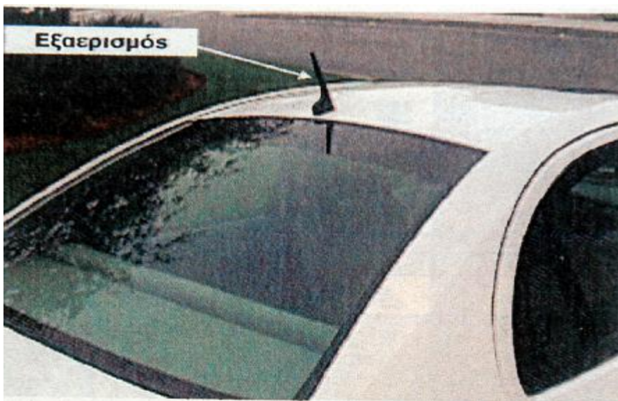
Εικόνα 7.10: Η εξαγωγή αερισμού του αυτοκινήτου από τυχόν διαρροές υδρογόνου έχει τη μορφή κεραίας στην οροφή του Ford P2000.
