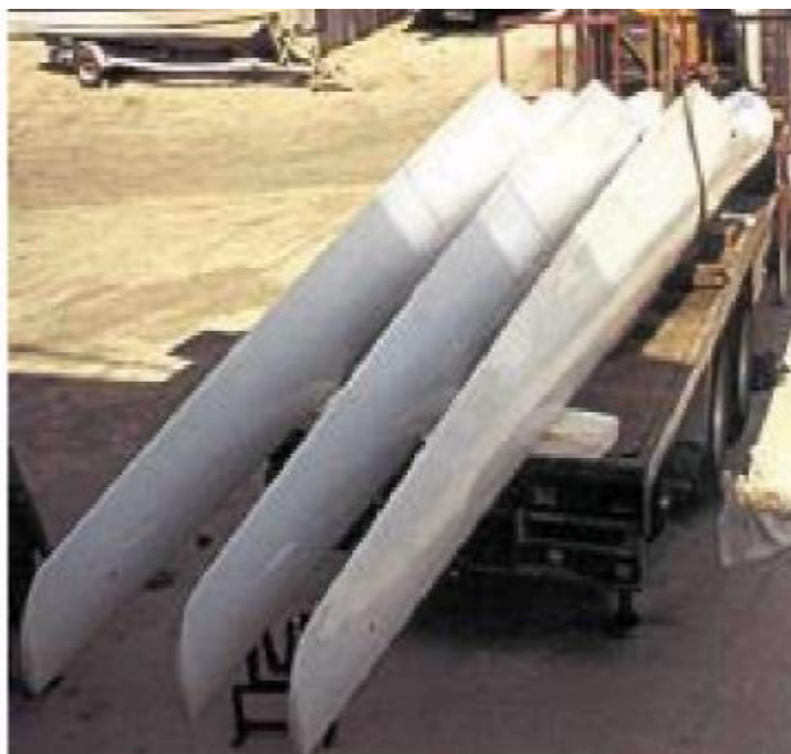
Σχήμα 3: Πτερύγια από ανεμογεννήτρια μήκους 24 μέτρων κατασκευασμένα από fibre-glass ενισχυμένο με πολυεστέρα
