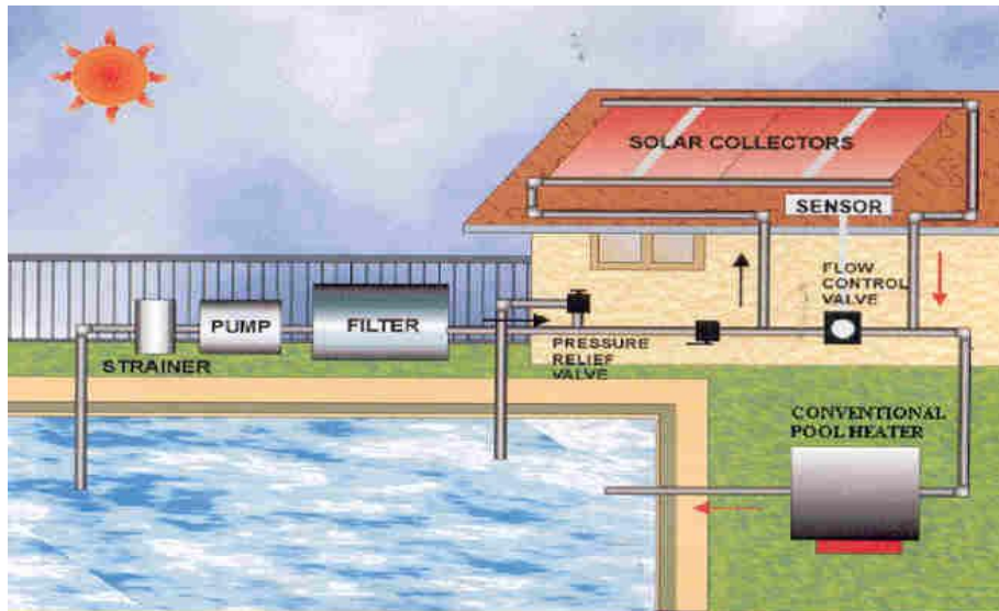
Απεικόνιση λειτουργίας ηλιακού συστήματος για θέρμανση πισίνας
