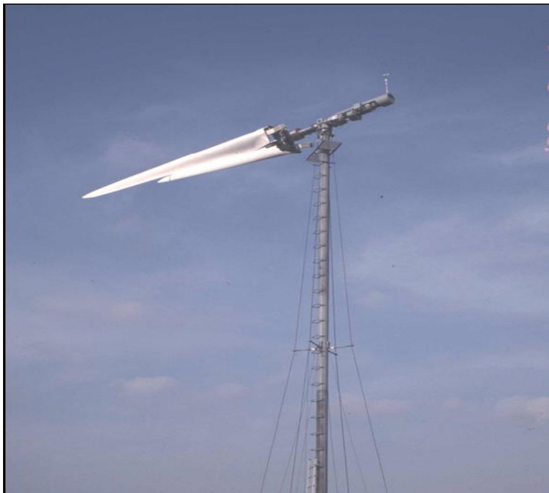
Εικόνα 1-10: η αρχή μιας εύκαμπτης ανεμογεννήτριας. Κατά τη διάρκεια σταθερής- βάσης (stand-still), τα πτερύγια αποκλίνουν αιφνίδια στον άνεμο.
