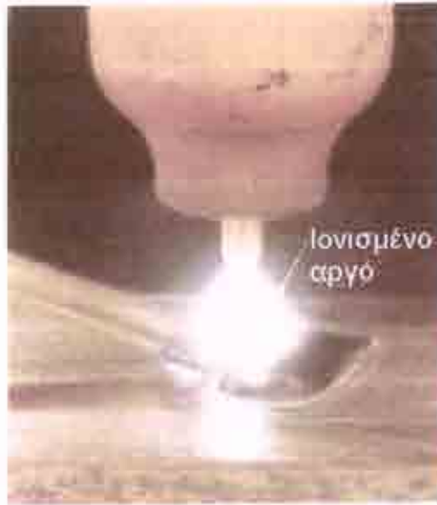
Σχήμα 27 Συγκεντρωμένη ιονισμένη στήλη αερίου αργού (από [25] επεξεργασμένο)
