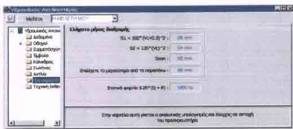
Σχήμα 3.20 : Φόρμα υπολογισμού προσκρουστήρα υδραυλικού ανελκυστήρα
