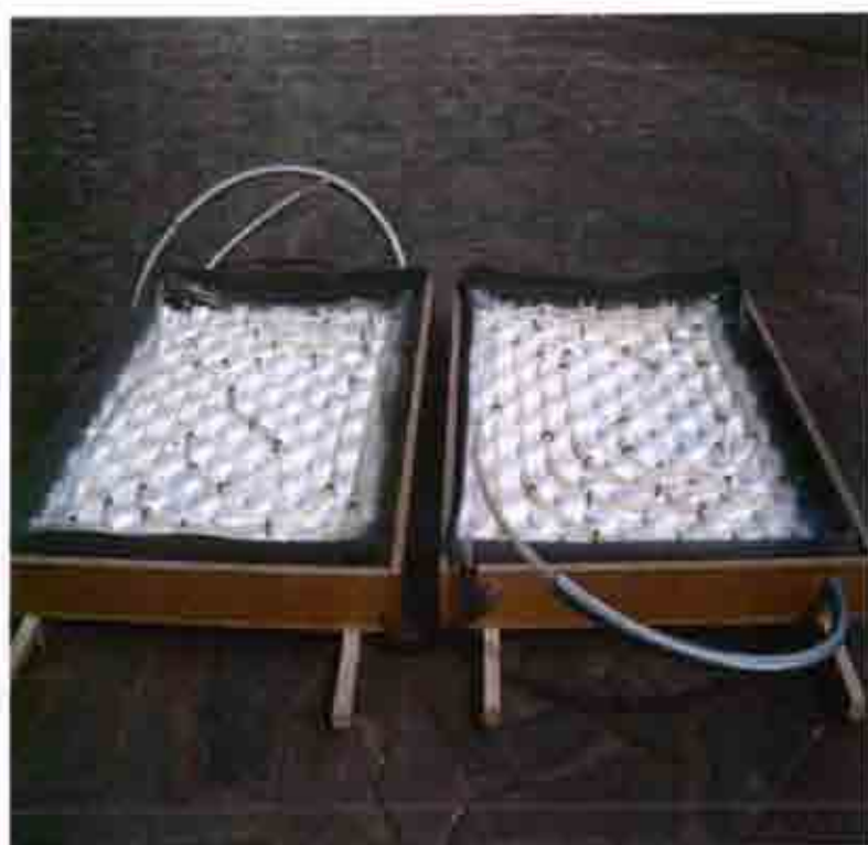
Εικόνα 26 : Ενδοδαπέδιο σύστημα πριν από την επικάλυψη του με βετον το οποίο έχει χρησιμοποιηθεί για την κατασκευή του κτιριακού ομοιώματος δοκιμών
