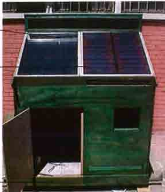
Εικόνα 5: Μοντέλο ηλιακής οικίας με ενδοδαπέδια θέρμανση και ηλιακό συλλέκτη
