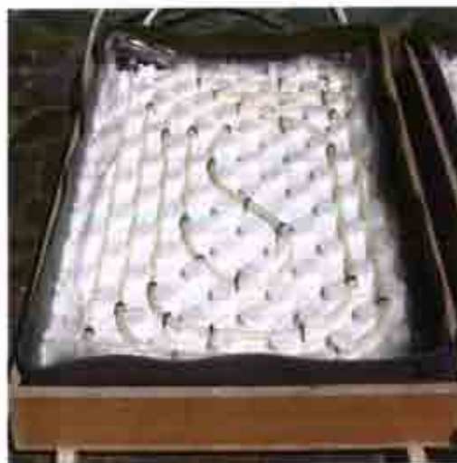
Εικόνα 43 : Μορφή του δαπέδου που έχει χρησιμοποιηθεί στο κτιριακό ομοίωμα δοκιμών
