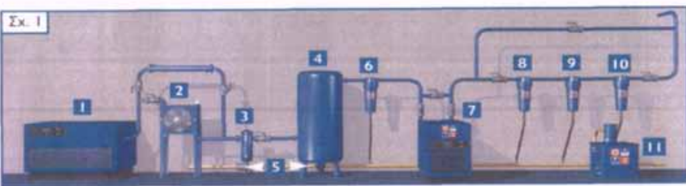
1. Αεροσ/αστής 2. Μεταψύκτης 3. Διαχωριστής 4. Αεροφυλάκιο 5. Αυτόματη αφυδάτωση 6. Φίλτρο QF 7. Ξηραντής 8. Φίλτρο PF 9. Φίλτρο HF 10. Φίλτρο CF 11. Διαχωριστής νερού - λαδιού
