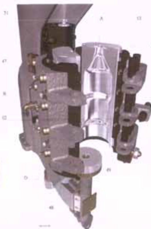
Σχ. 5.3.9 Μέρη καλούπιού και τρόπος στήριξης στον σταθμό εμφύσησης. (7)
