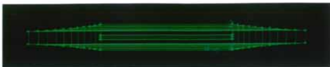
Σχήμα 5.2 Γεωμετρία του αγωγού στρέβλωσης της ροής
