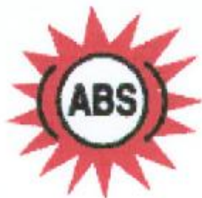
Σχ. 6.25 Ενδεικτική λυχνία ABS που βρίσκεται στο ταμπλό του αυτοκινήτου.
