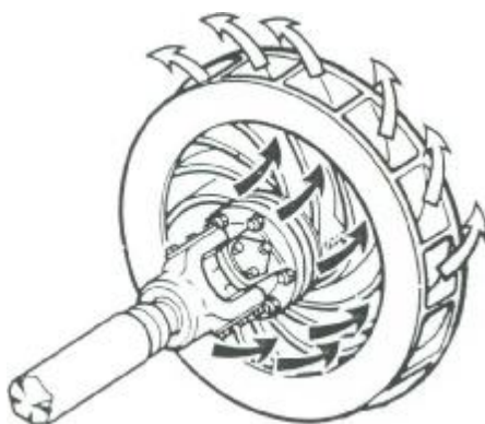
Σχ. 3.4 Σχηματική λειτουργία των πτερυγίων.
