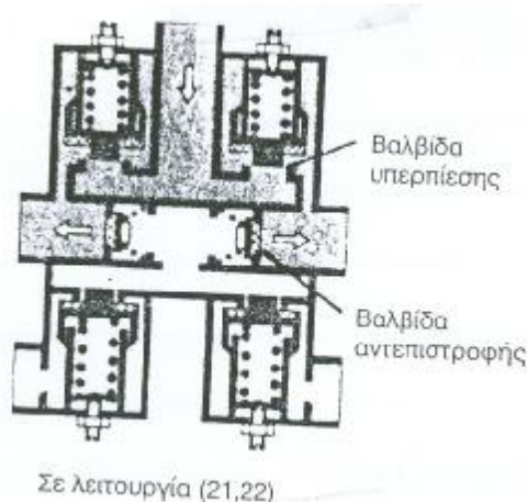
Σχ.2.8 Σχηματικό διάγραμμα προστατευτικής βαλβίδας 4 κυκλωμάτων.
