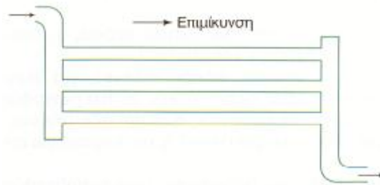
Εικ. 5.3. Σύνδεση σωλήνων με το σύστημα ορθογωνίου.
