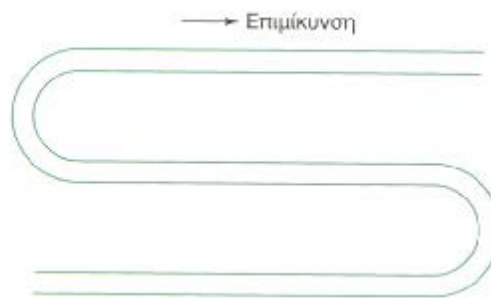
Εικ. 5.4. Σύνδεση σωλήνων με το σύστημα τρομπονιού.
