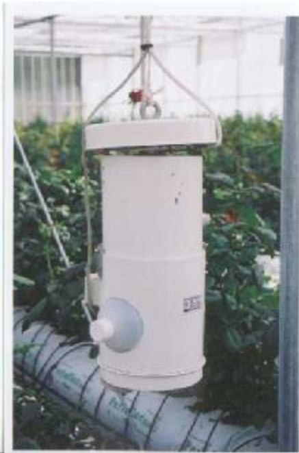
Φώτο 14: Ειδική συσκευή ανίχνευσης θερμοκρασίας και υγρασίας στο εσωτερικό του θερμοκηπίου.
