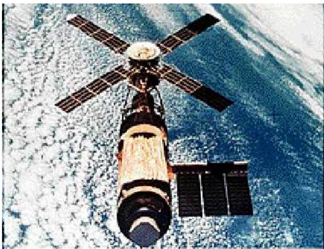
Σχήμα Α: Η χρήση των φ/β συστημάτων αναπτύχθηκε σε μεγάλο βαθμό στα διαστημικά προγράμματα, αφού αποτελούν ουσιαστικά τις πηγές ενέργειας των δορυφόρων.
