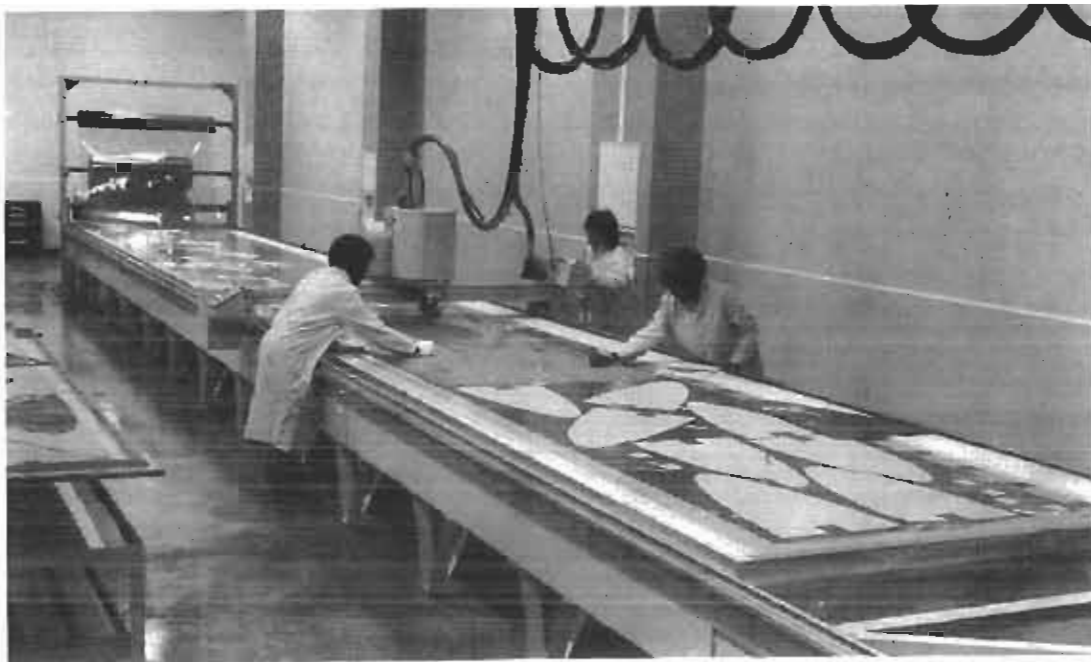
Σχ. 2-12: Κατασκευή εποξικού υλικού ενισχυμένο με ίνες άνθρακα
