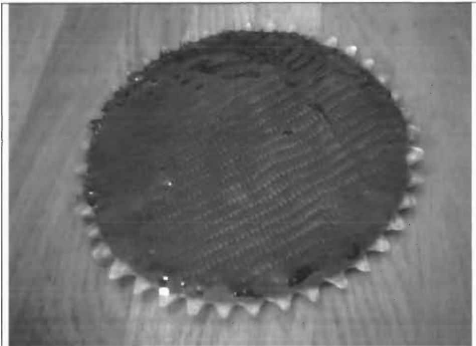
Σχ. 3-13: Γρανάζι από ανθρακονήματα και ρητίνη
