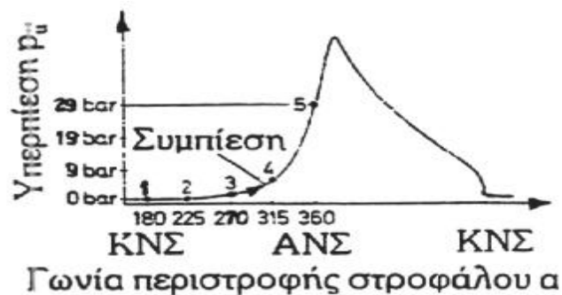
Σχ. 7 Καμπύλη πίεσης στο κύλινδρο σε συνάρτηση με τη γωνία περιστροφής \alpha του στροφάλου
