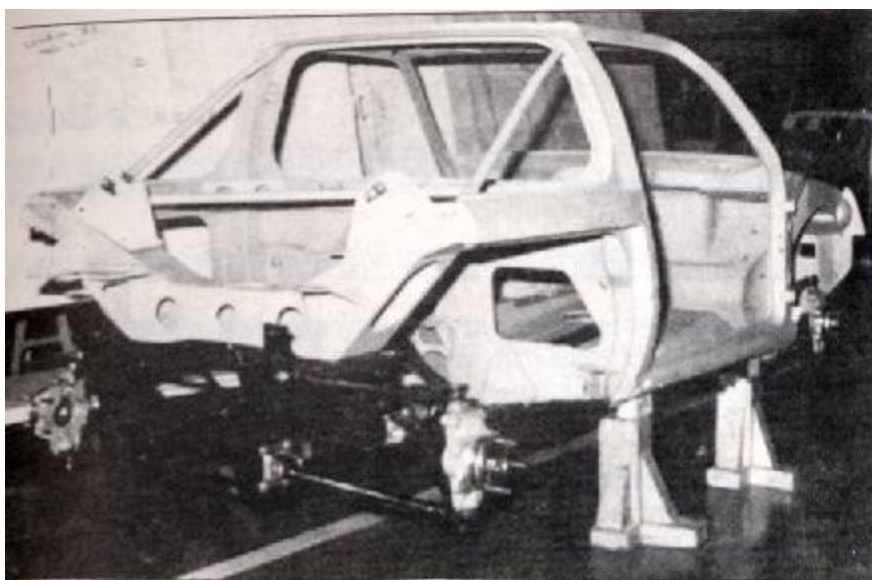
Εικόνα 6. (Ημιαυτοφερομενο αμάξωμα) PEUGEOT 205 T16 [Τεχνολογια Αμαξωμάτων]
