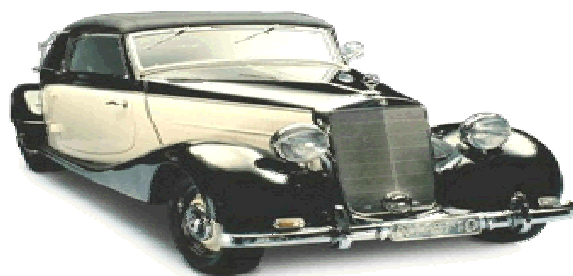
Εικόνα 9. (MERCEDES – BENZ 500 1938 Γερμανία 6 κυλ., 5401 cc, 170 Km / h). [ Car and Driver( Το χρονολόγιο του Αυτοκινήτου ) ]
