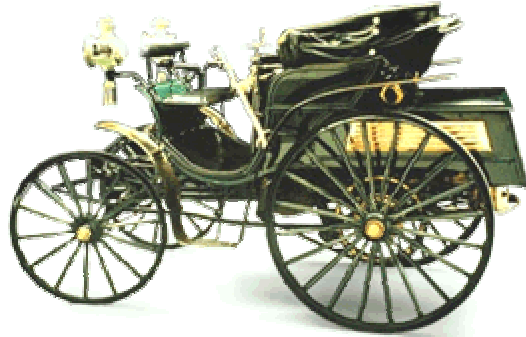
Εικόνα 4. (BENZ 1886 Γερμανία, κινητήρας μονοκύλινδρος 1000 cc, με μέγιστη ταχύτητα 15 Km / h). [ Car and Driver( Το χρονολόγιο του Αυτοκινήτου ) ]
