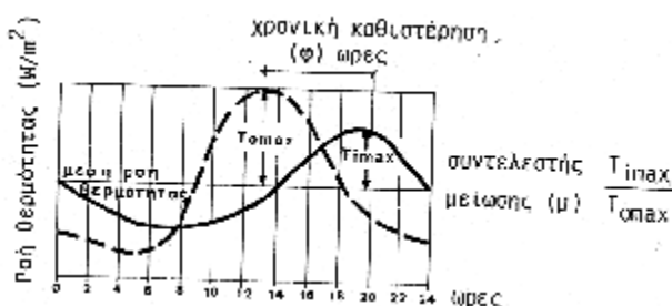
Σχήμα 2.12 Περιοδική μεταβολή της εξωτερικής θερμοκρασίας του αέρα και της εσωτερικής, επιφανειακής, για 24 ώρες.
