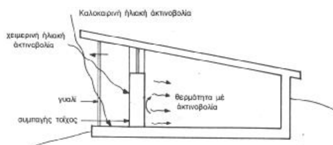
Σχήμα 3.6 Τοίχος θερμικής συσσώρευσης.
