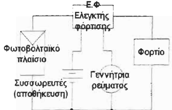
Σχήμα 3.2.4.1.1: Χρησιμοποίηση συσσωρευτών ως ενδιάμεσο στοιχείο αποθήκευσης ενέργειας μεταξύ PV-πλαισίων και φορτίου (περίπτωση α) και μεταξύ PV-πλαισίων-γεννήτριας και φορτίων (περίπτωση β).
