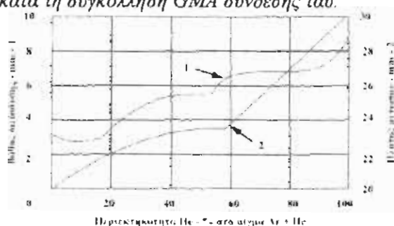
Σχήμα 31 Επίδραση της προσθήκης ηλίου, στην ατμόσφαιρα αργού, στη μορφή της κόλλησης, κατά τη συγκόλληση GMA ελαφρά κραματωμένων χαλύβων.
