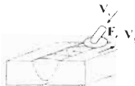
Σχήμα 8 Η σχέση της εγκάρσιας διατομής της κόλλησης με το τηκόμενο εναποτιθέμενο υλικό.
