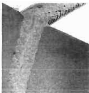
Σχήμα 10 Κόλληση εκτελεσμένη με πλασματικό καυστήρα σε οξύμαχο χάλυβα πάχους 7.5[mm] η κόλληση I χωρίς διάκενο
