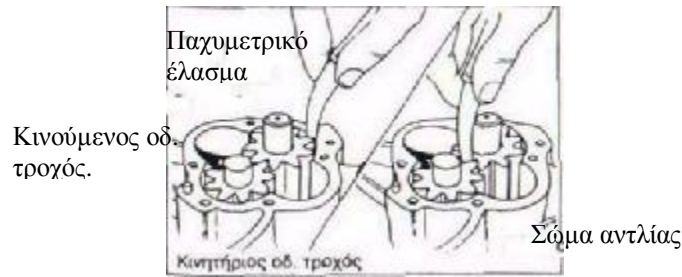
Σχ.4.14 Εξαρτήματα Γραναζωτής αντλίας έλεγχος πλευρικών και αξονικών διακένων
