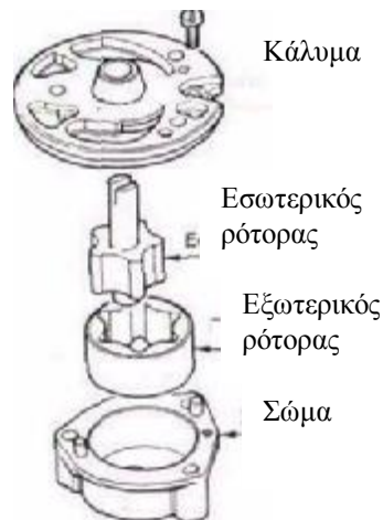
Σχ.4.15 Εξαρτήματα αντλίας λαδιού με λοβούς (ρότορες).
