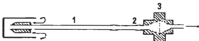
Σχήμα 8.10.1 Σύστημα δειγματοληψίας αποτελούμενο από δύο απογυμνωτές (1,2) και φίλτρο διήθησης (3). Απογυμνωτής 1: 90x0,6 cm, εσωτερική κάλυψη με NaF, συγκρατούνται HCl και HNO 3 . Απογυμνωτής 2: 25x0,6 cm, εσωτερική κάλυψη με άλας τετραχλωροϋδραργύρου, συγκρατούνται SO 2 και H 2 S
