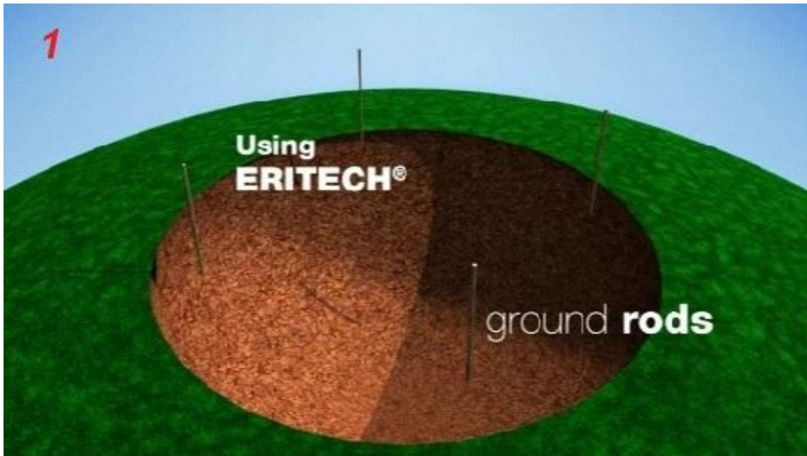
Εικόνα 5.68 : Εγκατάσταση ηλεκτροδίων γείωσης.[24]
