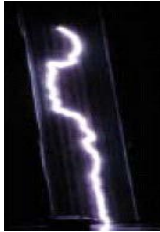
Εικόνα 5.26: Διάσπαση σε στρώμα με 30% αντιμόνιο [18]
