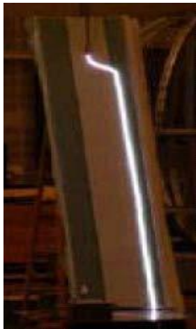
Εικόνα 5.24: Διάσπαση στο επικαλυπτικό στρώμα με 10% αντιμόνιο [18]
