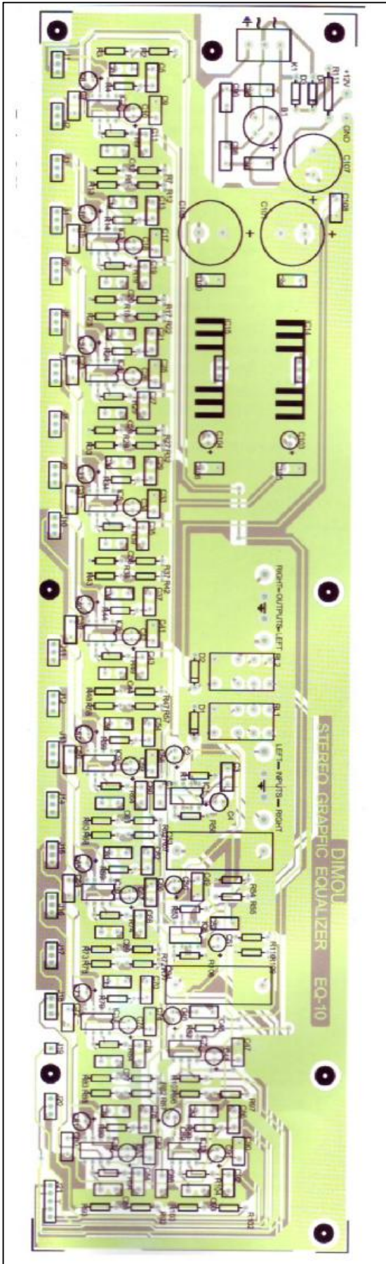
Εικόνα 4.6. Η τοποθέτηση των εξαρτημάτων στην πλακέτα των φίλτρων και του τροφοδοτικού.
