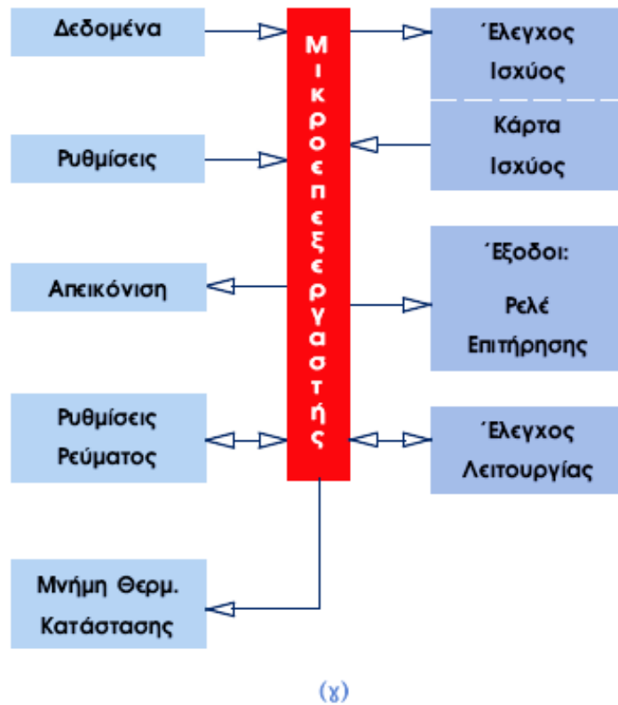
Σχ. 2.43: Ηλεκτρονικός εκκινητής α) Συνδεσμολογία θυρίστορ, β) Τάση τροφοδότησης κινητήρα και γ) Λειτουργίες μικροεπεξεργαστή.
