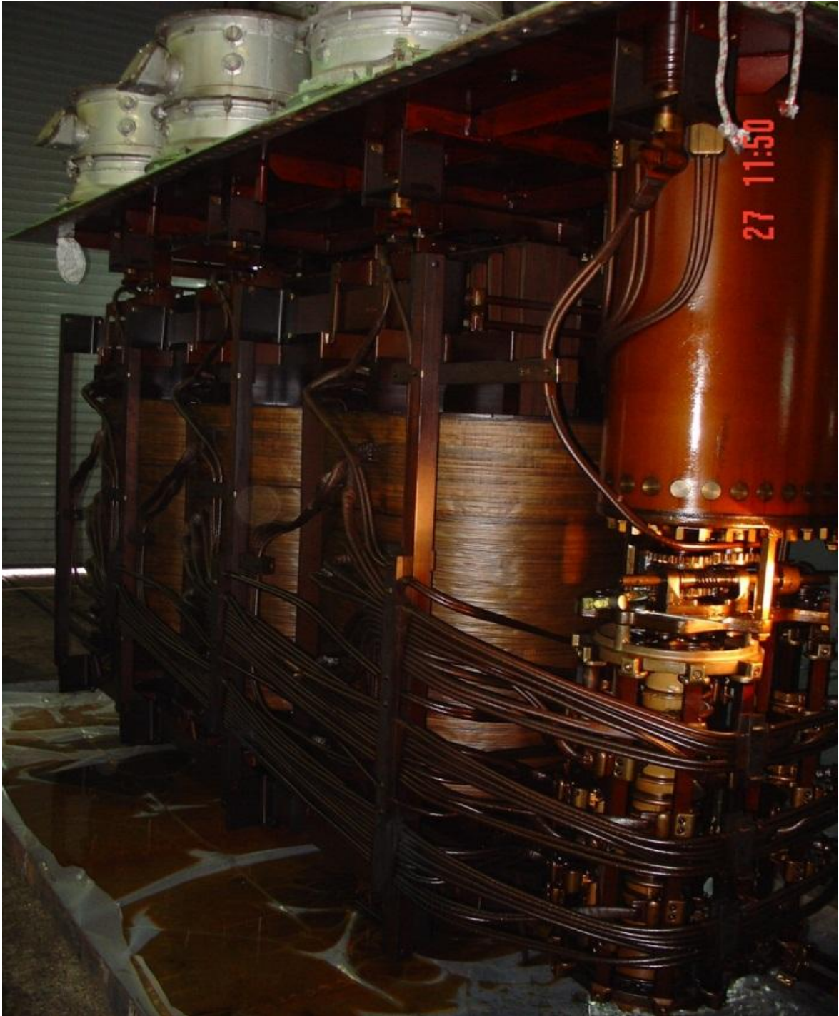
Σχήμα 17. Το εσωτερικό μέρος του Μ/Σ Ισχύος. Διακρίνονται αριστερά τα τρία τυλίγματα και δεξιά ο μεταγωγέας.
