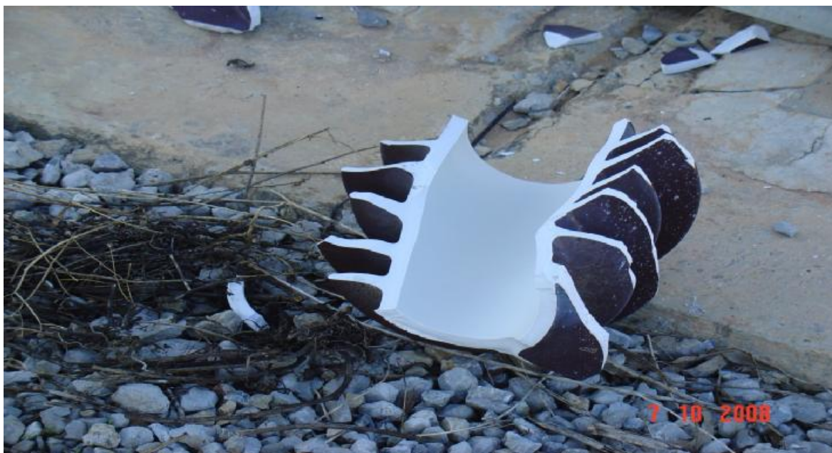
Σχήμα 64. Τεμάχια από σπασμένο μονωτήρα Διακόπτη που έχουν εκσφενδονιστεί μακριά μετά από βραχυκύκλωμα και έκρηξη.
