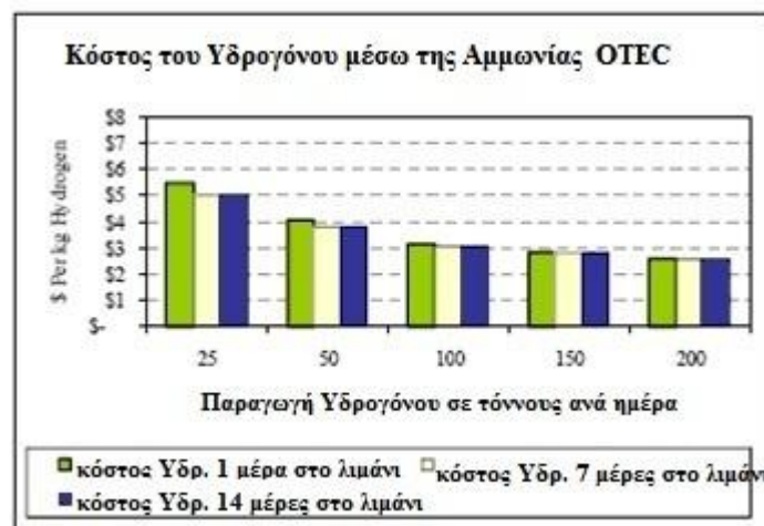
Σχήμα.4.8.2(β) Η γενική τάση των τιμών για τις μελλοντικές μονάδες αμμωνίας OTEC είναι παρεμφερής με τις μονάδες υγρού υδρογόνου, αλλά το συνολικό κόστος είναι μικρότερο.
