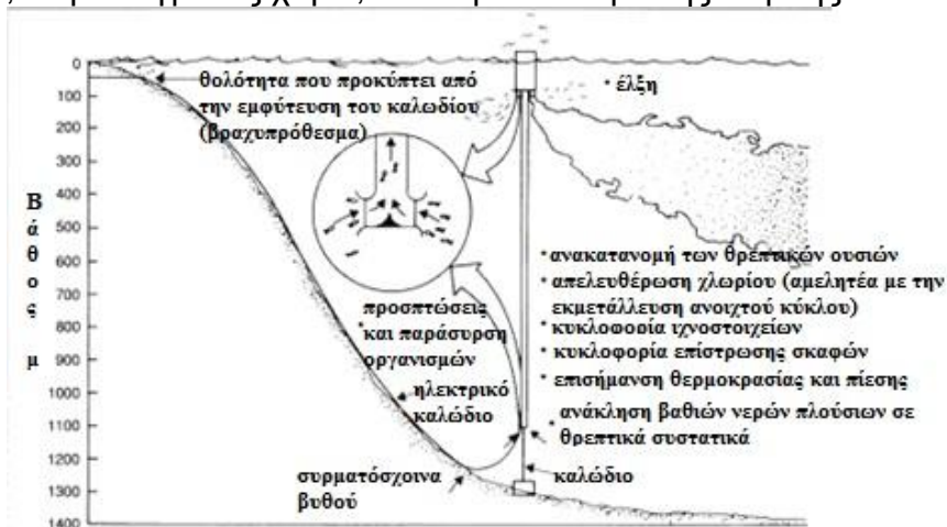
Σχήμα 5.3: Περιβαλλοντικές επιπτώσεις από την λειτουργία εγκατάστασης OTEC
