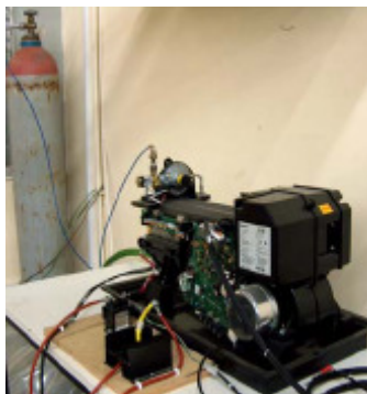
Σχήμα 3.11: Πειραματική μονάδα παραγωγής ηλεκτρικής ενέργειας με κυψέλες καυσίμου σε εκπαιδευτικό ίδρυμα.
