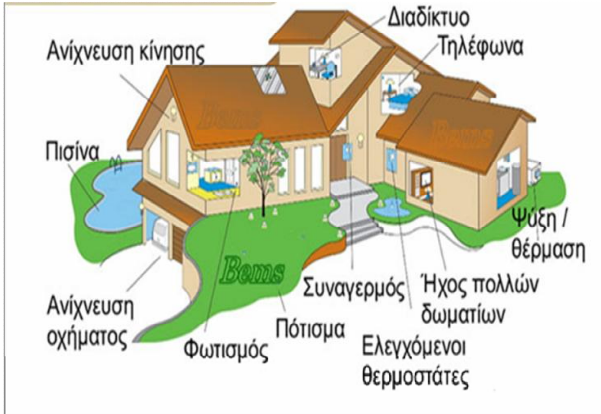
Σχήμα 2: Έλεγχος Έξυπνου Σπιτιού μέσω Αυτοματισμών
