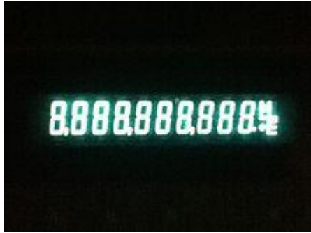
Εικόνα 6.4 Ψηφιακή οθόνη μιας αριθμομηχανής (electronic calculator) [ http://en.wikipedia.org/wiki/Display_technology ].
