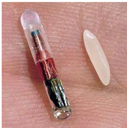
Εικόνα 6.26 Σύγκριση μεγέθους ενός RFID μικροτσιπ με έναν κόκκο ρυζιού [ http://en.wikipedia.org/wiki/Radio-frequency_identification ].
