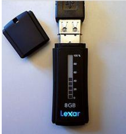
Εικόνα 6.16 Οθόνη κατάστασης σε μνήμη USB (USB flash drive). Εδώ, το μελάνι χρησιμοποιείται ως μετρητής χωρητικότητας, δηλώνοντας έτσι τη διαθέσιμη μνήμη της USB συσκευής [ http://en.wikipedia.org/wiki/Electronic_paper#Status_displays ].
