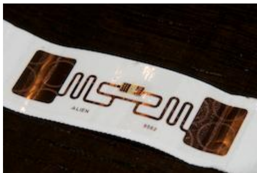
Εικόνα 6.33 Η πίσω πλευρά μιας διαθέσιμης ετικέτας RFID που χρησιμοποιείται για χρονομέτρηση αγώνων [ http://en.wikipedia.org/wiki/Transponder_timing#Usage και http://en.wikipedia.org/wiki/File:Back_side_of_disposable_RFID_tag_used_for_race_timing.png ].
