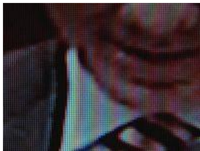
Εικόνα 6.6 Κοντινό πλάνο φωτογραφίας μιας LCD οθόνης τηλεόρασης, στην οποία διακρίνονται μπλε, κόκκινα και πράσινα pixel. Η εικόνα απεικονίζει έναν άνδρα με κοστούμι και γραβάτα [ http://en.wikipedia.org/wiki/Liquid_crystal_display#Quality_control ].
