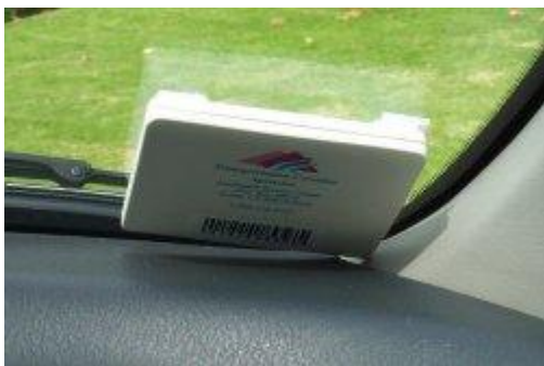
Εικόνα 6.29 Ετικέτα RFID για ηλεκτρονική είσπραξη διόδων (electronic toll collection ή ETC). Πολλά συστήματα ETC χρησιμοποιούν αναμεταδότες (transponders) σαν αυτόν που παρουσιάζεται στην εικόνα για ηλεκτρονική χρέωση λογαριασμών των καταχωρημένων αυτοκινήτων χωρίς την ανάγκη διακοπής της κυκλοφορίας [ http://en.wikipedia.org/wiki/Radio-frequency_identification#History και http://en.wikipedia.org/wiki/Electronic_toll_collection#Overview ].
