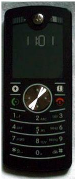
Εικόνα 6.17 Κινητό τηλέφωνο Motorola F3. Το μοντέλο αυτό χρησιμοποιεί μια οθόνη ηλεκτρονικού χαρτιού αντί μιας LCD [ http://en.wikipedia.org/wiki/Electronic_paper#Mobile_phones ].
