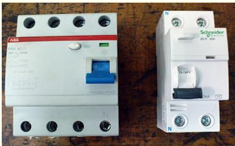
Τριφασικό (4X40) και μονοφασικό (2x40) αντιηλεκτροπληξιακά ρελέ τύπου AC.
