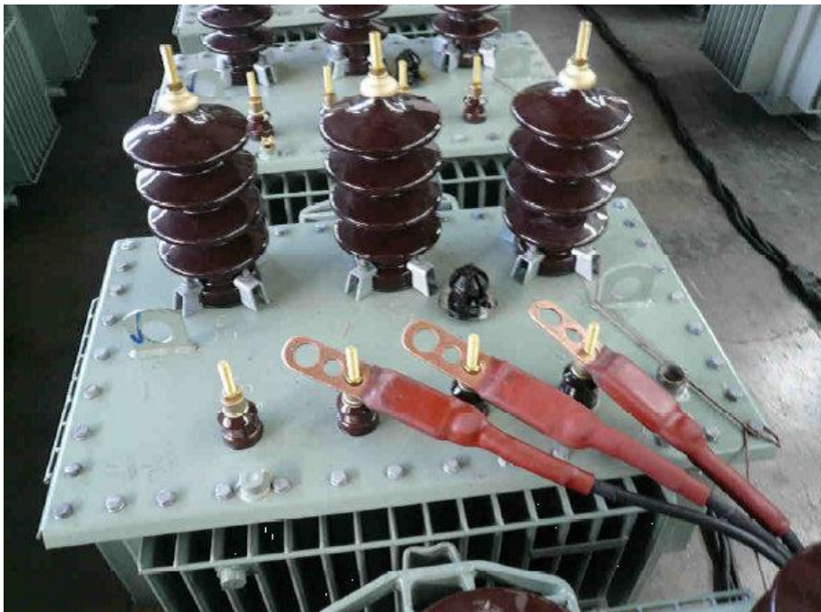
Εικόνα 15 : Δοκιμή μέτρησης απωλειών σιδήρου και ρεύματος μαγνήτισης
