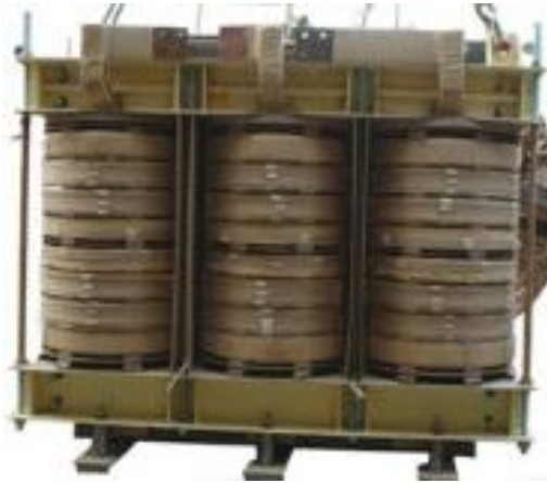
Εικόνα 10 : Pressboard στους πυρήνες του μετασχηματιστή
