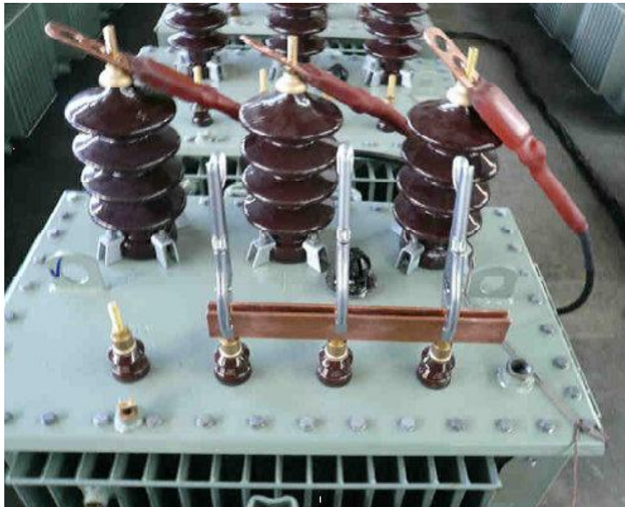
Εικόνα 13: Συνδεσμολογία μέτρησης απωλειών φορτίου και τάσης βραχυκύκλωσης
