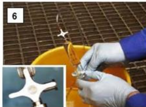
Εικόνα 19 : Βήματα λήψης δείγματος για ανάλυση διαλυμένων
