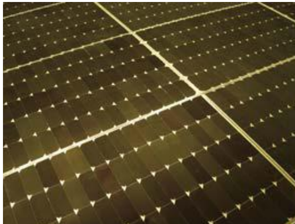
Εικόνα 19 : Φωτοβολταϊκό στοιχείο Αρσενικού Γαλλίου [15]
