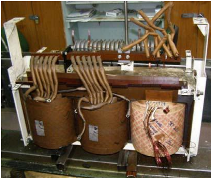
Σχ. (5.8.11): Εσωτερικό Μ/Σ
