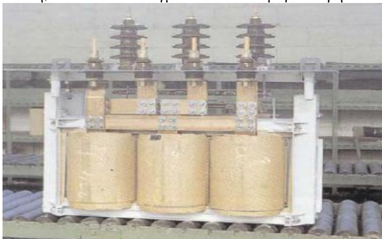
Σχ. (5.8.10): Εσωτερικό ΜΣ Πυρήνας με τα τυλίγματα ΥΤ και ΧΤ για κάθε φάση
