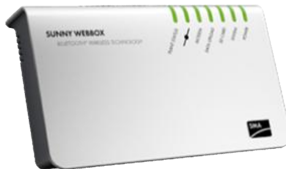
Εικόνα 28 Συσκευή τηλεμετρίας Sunny WebBox
