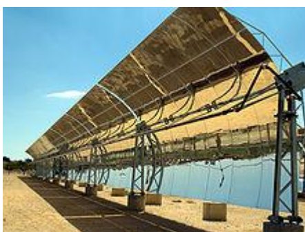
Εικ. 2.8 Ένα ηλιοθερμικό Παραβολικού κοίλου ή γούρνα. Είναι κατασκευασμένο ως ένα μεγάλο παραβολικό κάτοπτρο (συνήθως έχει ασημένια επικάλυψη ή γυαλισμένο αλουμίνιο) με ένα σωλήνα Dewar που τρέχει κατά το μήκος του σε κομβικό σημείο. Το φως του ηλίου αντανακλάται από τον καθρέφτη και επικεντρώνεται στο σωλήνα Dewar, θερμαίνοντας υγρό το οποίο στην συνέχεια μετατρέπει κινητική ενέργεια σε ηλεκτρισμό. Η γούρνα συνήθως ευθυγραμμίζεται με άξονα βορρά-νότου, και περιστρέφεται έτσι ώστε να παρακολουθεί τον ήλιο στον ουρανό κάθε μέρα.
