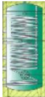
Εικ. 4.25 Εναλλάκτης σωληνοειδούς τύπου.
