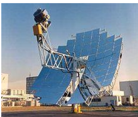
Εικ. 2.7 Ένα ηλιοθερμικό παραβολικό πιάτο με κάτοπτρα. Αυτός ο συλλέκτης είναι υψηλής θερμοκρασίας. Συγκεντρώνει τις ακτίνες του ηλίου στην δεξαμενή μιας μηχανής Stirling. Το πιάτο ακολουθεί τον ήλιο κατά την διάρκεια της μέρας.
