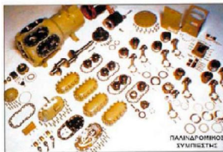
Εικόνα 4.9 Σύγκριση των κινούμενων μερών κοχλιωτού και ενός παλινδρομικού συμπιεστή.
