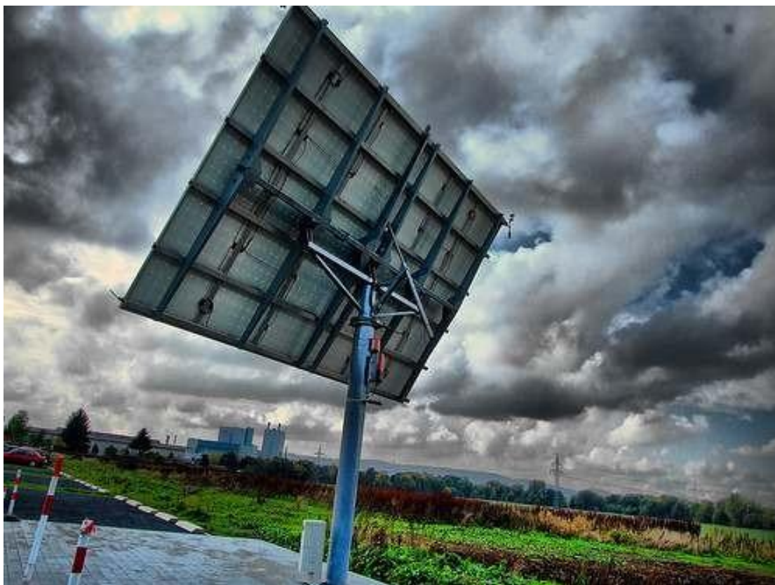
Διατάξεις ιχνηλάτησης της πορείας του ήλιου διπλού άξονα
