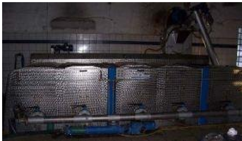
Εικόνα 3: Δεξαμενές για τη μάλαξη της ελαιοζύμης
