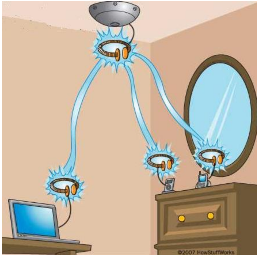
Εικόνα (27) Διάταξη ασύρματης μεταφοράς ενέργειας σε οικιακές συσκευές.
