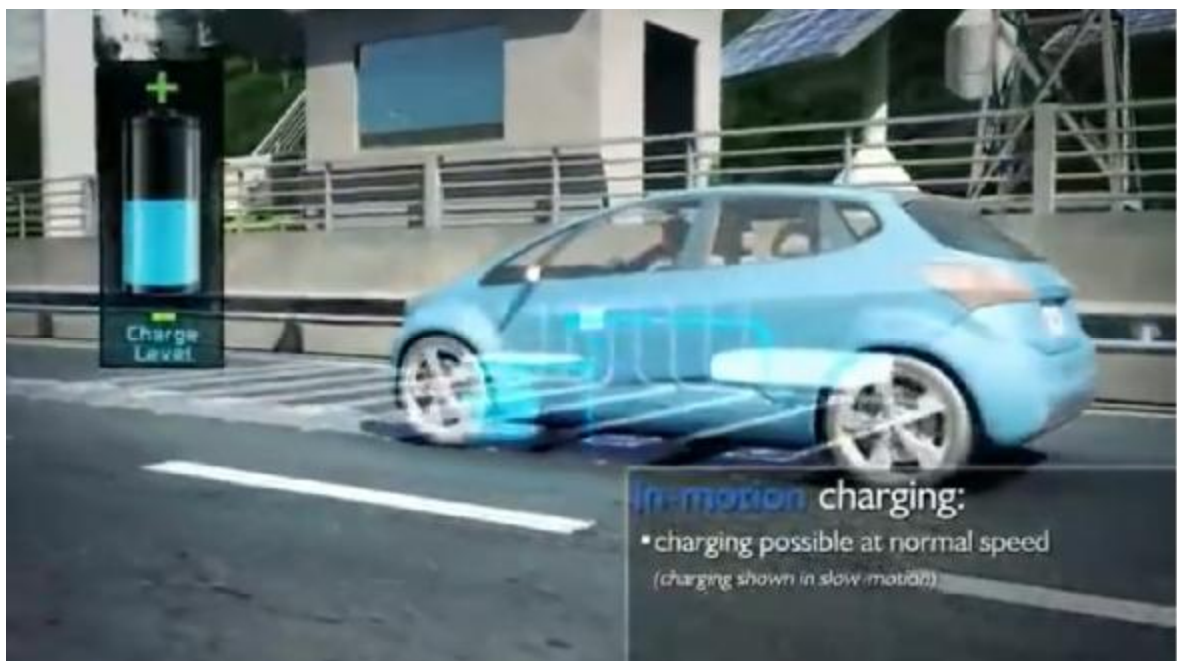
Εικόνα (21) Ασύρματη φόρτιση οχήματος κατά την κίνηση σε αυτοκινητόδρομο , οδηγός κινείται κατά μήκος τον μπόμπων και απορρόφα το αναγκαίο φορτίο
