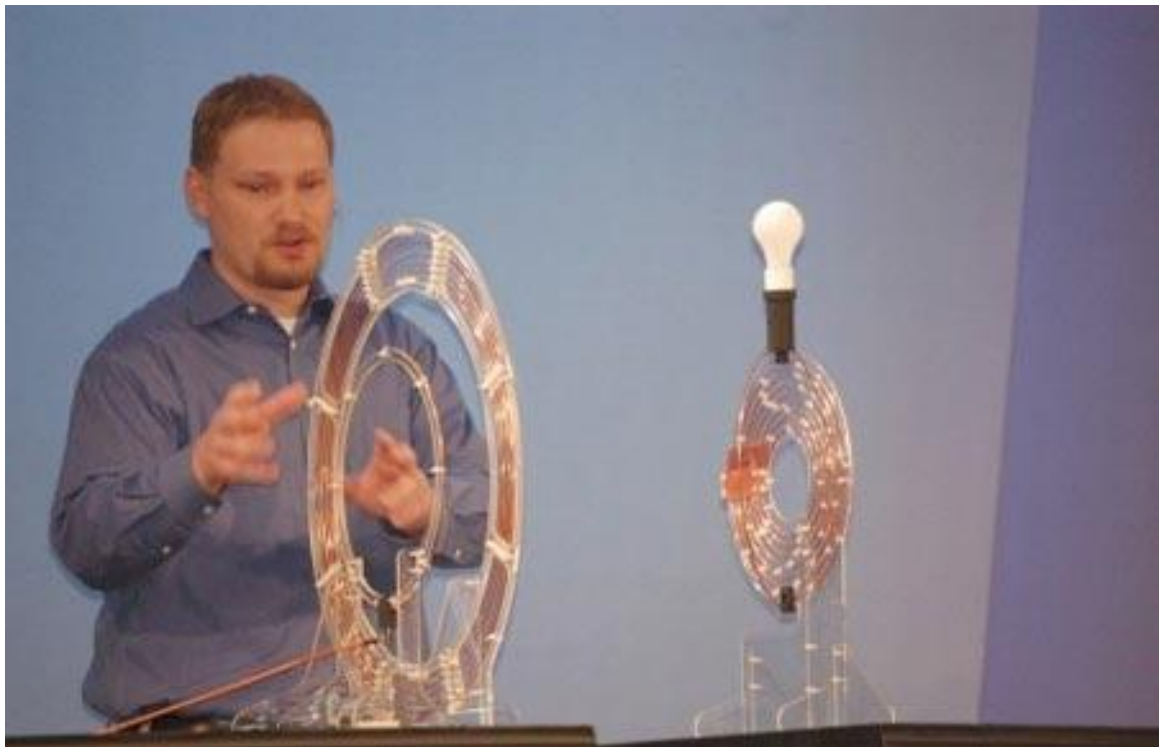
Εικόνα (7) Το πείραμα της Intel το 2008 στο IDF βασισμένο στο πείραμα του MIT αλλά με διαφορετική διάταξη πηνίων ( Pancake coil)
